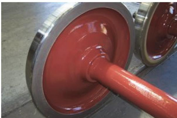
*Abbildung 4: Beispiel für eine Radsatzbeschichtung Quelle: BASF-Coatings*
